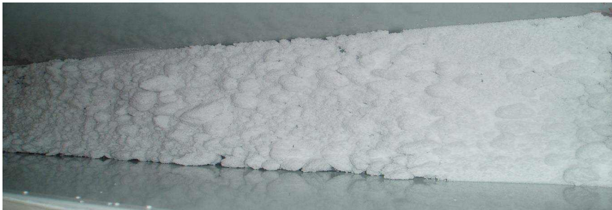
图 5 Teubert 消失模专用预发泡机和国产预发泡机预发泡珠粒对比
